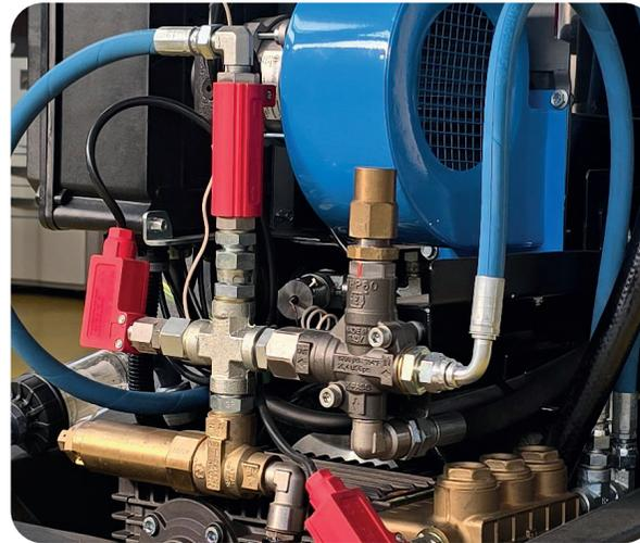
del bruciatore. Questo sistema garantisce l'arresto della combustione anche nel caso in cui l'acqua non circoli più nel serpentino, evitando il rischio di surriscaldamento.
